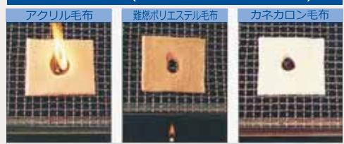
〈カネカロン〉は火源に接しても溶融しにくく、炭化することによってすみやかに消火します。他繊維では燃焼によって溶融し、高熱の溶融物が滴下、身体の損傷(重度の火傷)を招いたり、さらに燃焼を拡げる恐れがあります。
