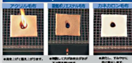
●炎を上げて燃え上がります。 ●燃焼して穴が空く火が下で燃え広がります。 ●炭化し、すみやかに自己消火します。
